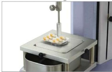
45 Testkit für die Tablettenextrusion
