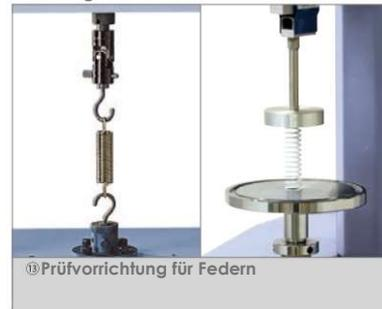
⊗ Prüfvorrichtung für Federn
