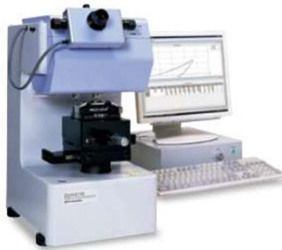
Elektromagnetische Prüfmaschine EMT
