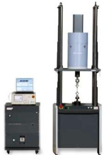
SERVOPULSER Hydraulisch-dynamische Prüfmaschine
