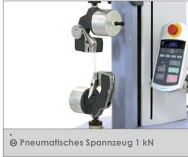
⊗ Pneumatisches Spannzeug 1 kN
