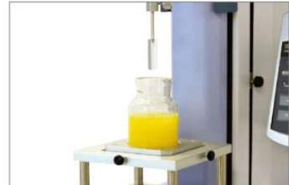
① Steifigkeitstestkit für Gelatineproben
