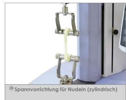
⑱ Spannvorrichtung für Nudeln (zylindrisch)
