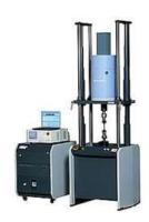
Durch den elektromagnetischen Antrieb arbeitet die Prüfmaschine leise und umweltfreundlich. Trotz der hohen Frequenz sind große Amplituden möglich.
